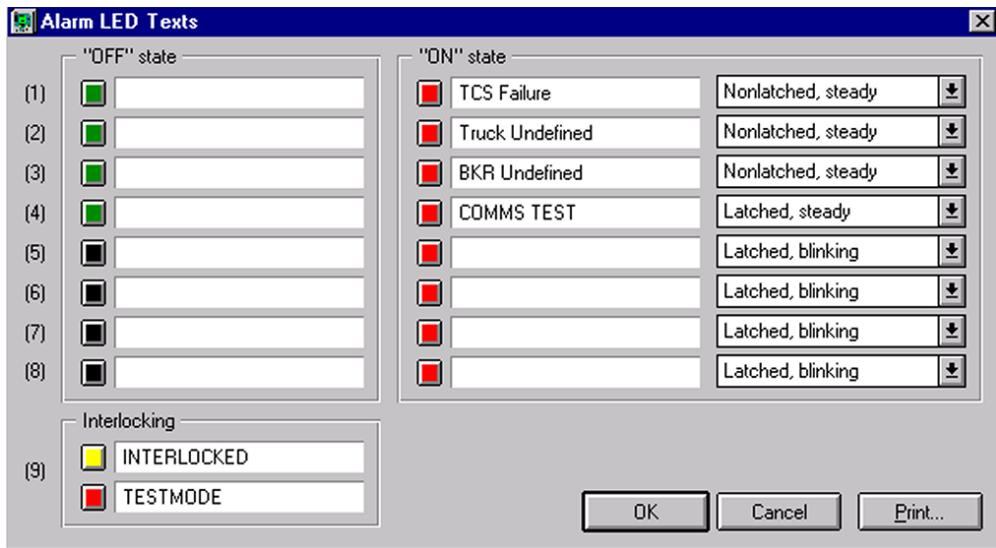
Slika 3.5: Primjer konfiguracije alarma alatom *Relay Mimic Editor*
