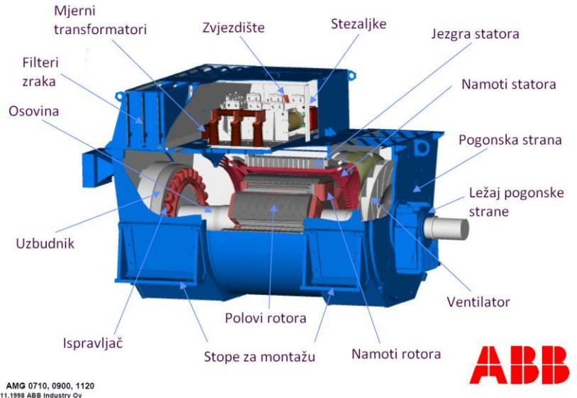
Slika 2.2: Glavne komponente sinkronog generatora proizvođača ABB
