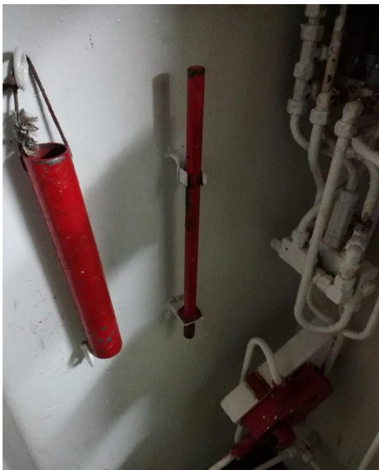
Slika 19. Prikaz poluge za otvaranje/zatvaranje vodonepropusnih vrata u slučaju nužde na putničkom brodu „Berlin“
