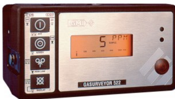
Slika 13. Univerzalni uređaj GMI Gasurveyor 500.
