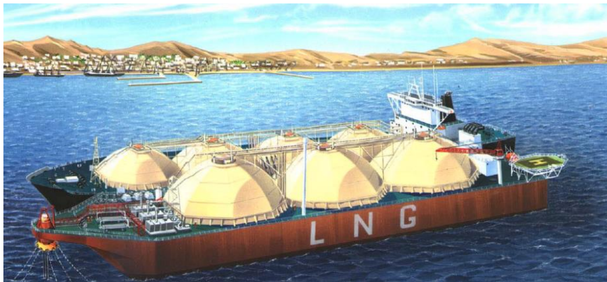
Slika 6. Plutajuće postrojenje za skladištenje i uplinjavanje LNG-a [10]
