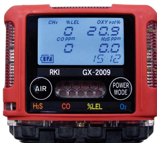
Slika 20. RKI prijenosni uređaj za mjerenje plinova
