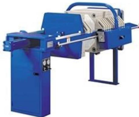
Slika 19. Uređaj za isušivanje *sludgea*.[10]
