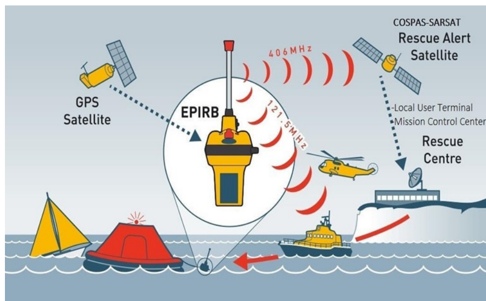
Slika 9. Uzbunjivanje u COSPAS-SARSAT sustavu.
