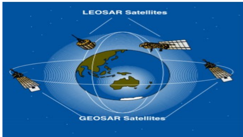
Slika 5. Putanje LEOSAR i GEOSAR satelita.
