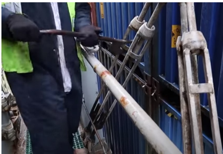
Slika 21. Prikaz lučkog radnika pri učvršćivanju stezaljke ( turnbuckle )
