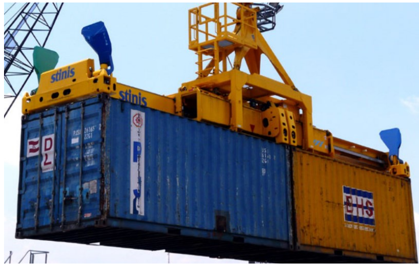
Slika 12. Spreader za zahvaćanje dva kontejnera od 20 stopa
