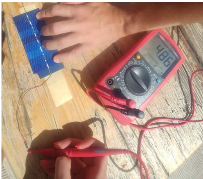
Slika 4.9 Spoj solarnih panela u seriju (5 V)
