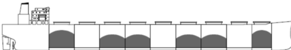
Slika 19 – “Blok” način krcanja tereta
