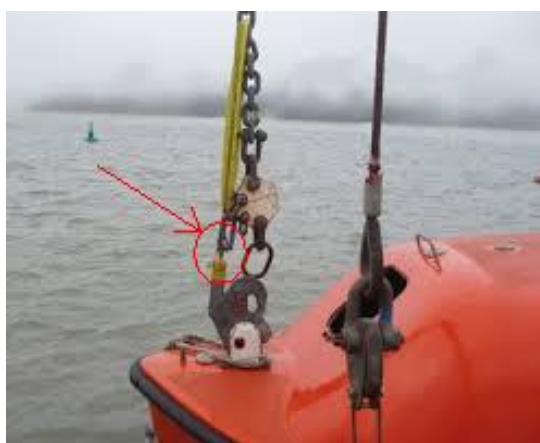
Slika 16. Ue za vješanje brodice prilikom održavanja kuka
