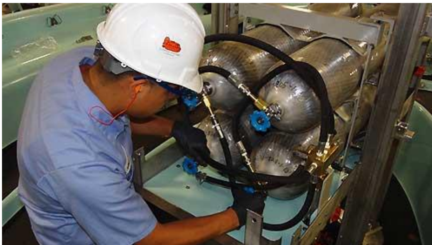
Slika 8. Sustav opskrbe zrakom brodice za spašavanje
