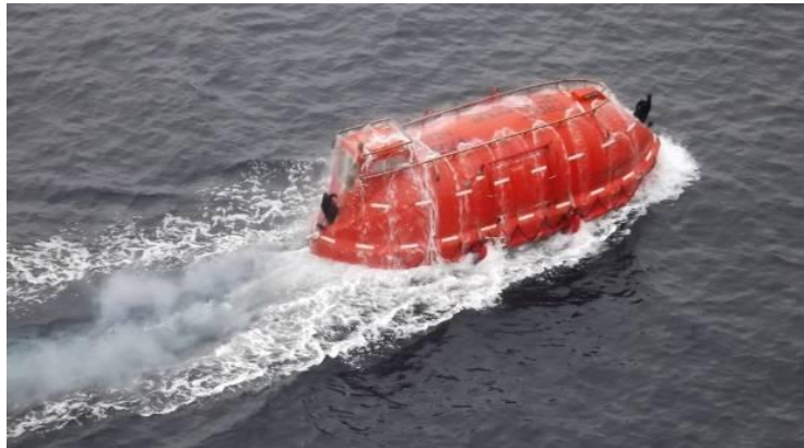
Slika 9. Brodica za spašavanje otporna na vatru s vodenom zavjesom
