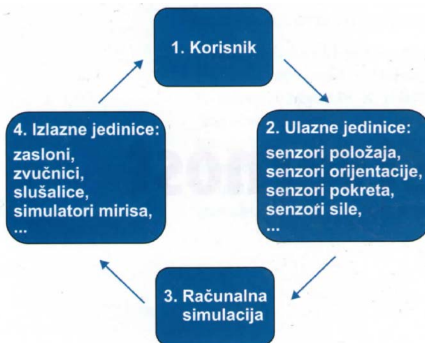
Slika 1. Princip komunikacije između korisnika i računala u virtualnoj stvarnosti
