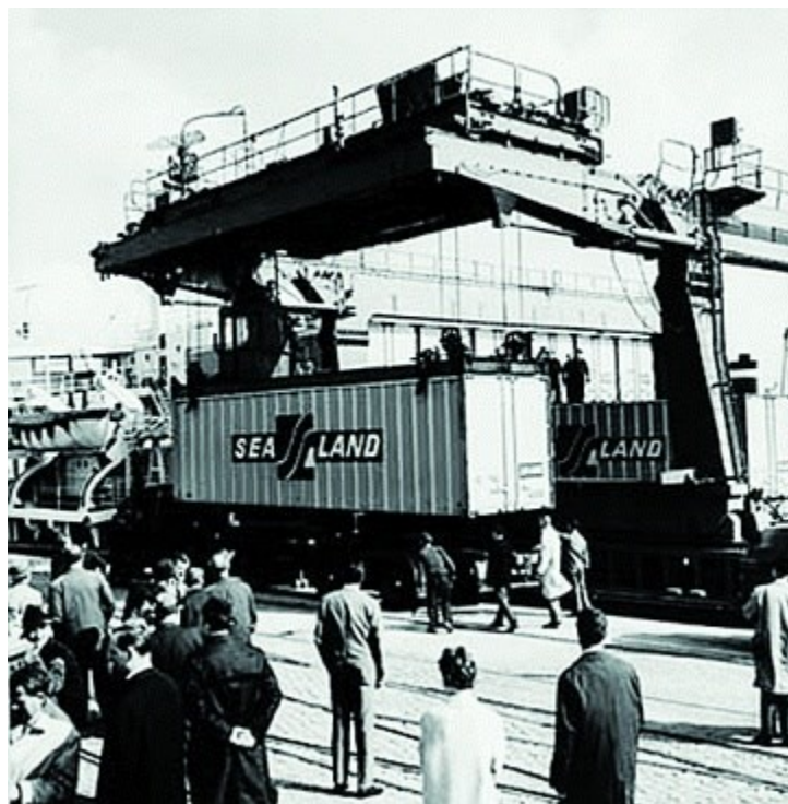
Slika 2. Prekrcaj kontejnera s kamiona na brod.
