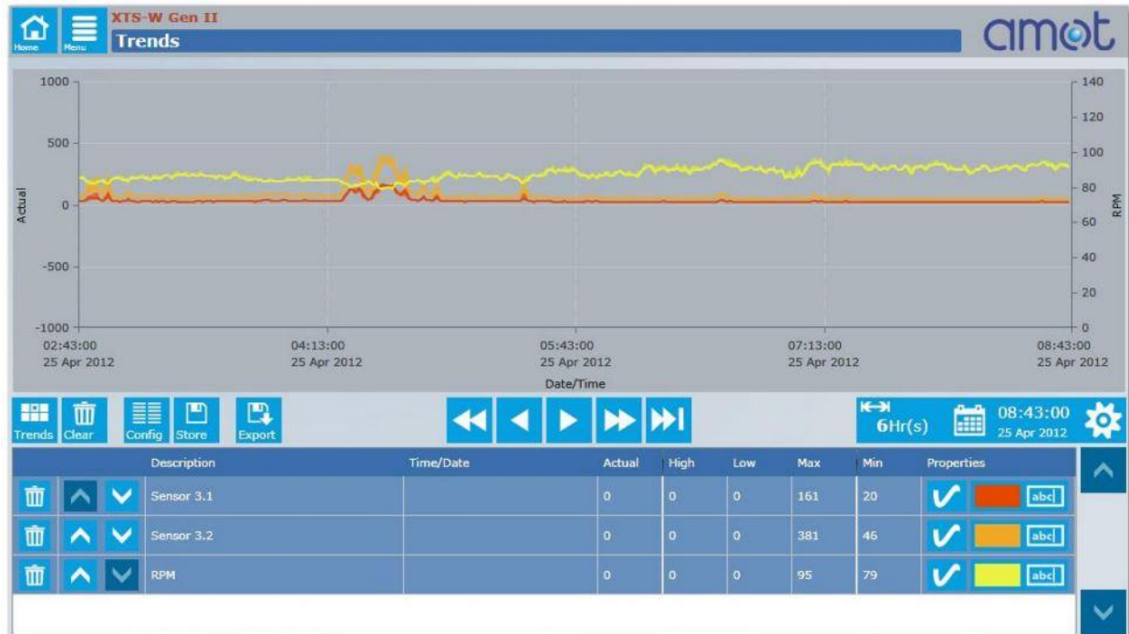
Slika 25. Prikaz krivulja dvaju mjerenja senzora i krivulje broja okretaja (Izvor: AMOT software manual)
