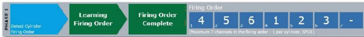
Slika 37. Prikaz redoslijeda paljenja cilindara (Izvor: AMOT software manual)
