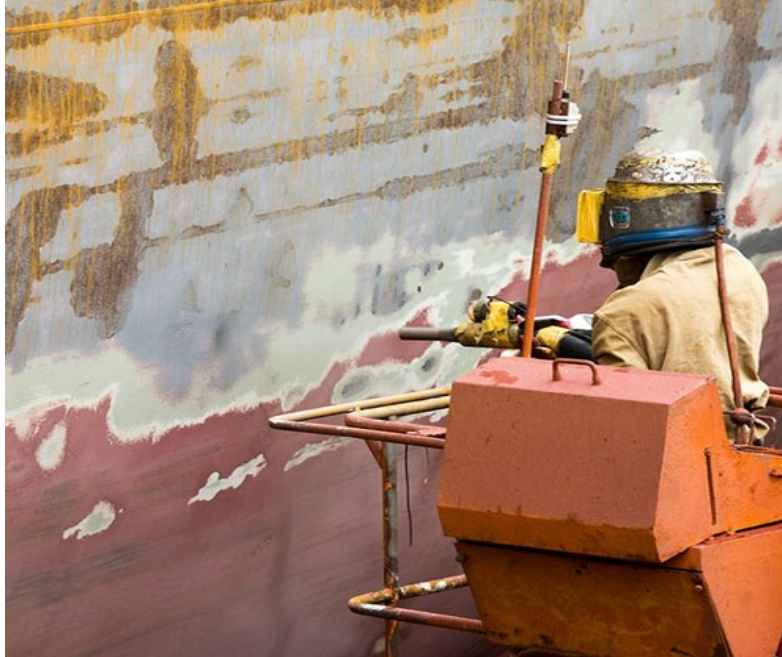
Slika 11. Pjeskarenje- Suha priprema broskog trupa; Izvor [11]
