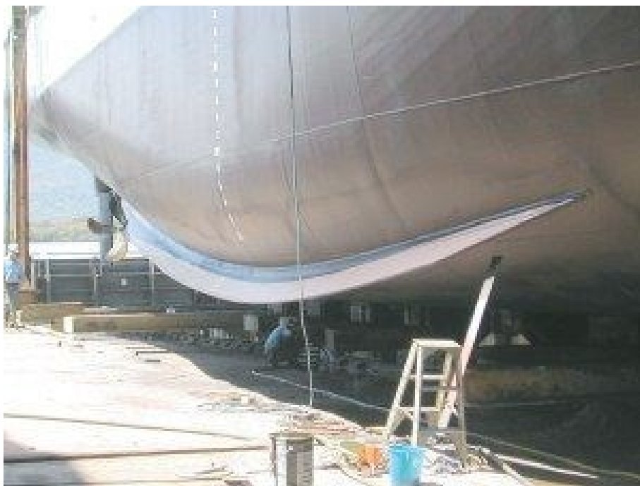
Slika 9. Prikaz kaljužne kobilice u dokovanju broda; Izvor [8].
