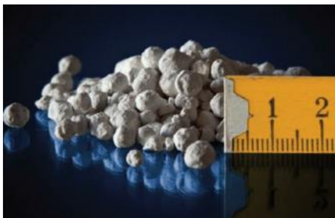
Slika 10: prikaz kuglica kalcijevog hidroksida i njihove veličine (izvor: Alfa Laval: Understanding exhaust gas treatment systems , 2012., Calcium hydroxide granules )
