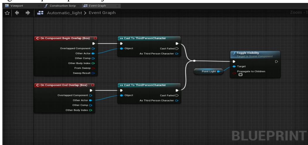
Slika 3.Blueprint graf za paljenje/gašenje svjetla
