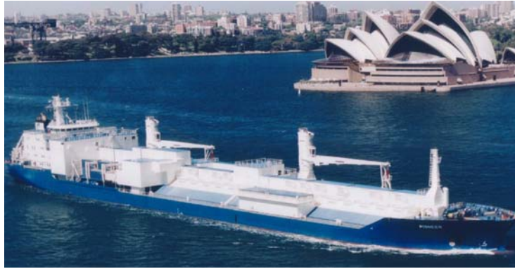
Slika 19. BICO brod ( Bulk in, Bags out ).
