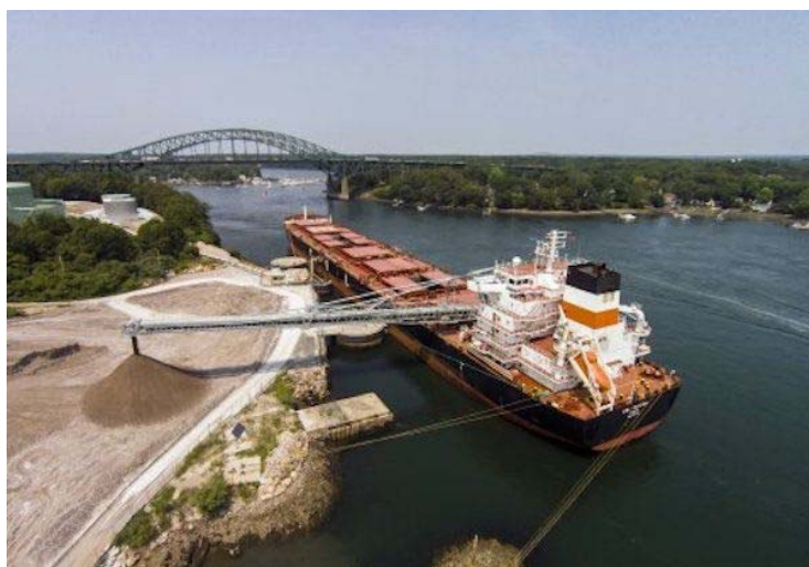
Slika 17. Brod samostalno iskrcava teret ( self unloader ).
