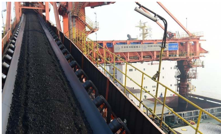
Slika 5. Proces ukrcaja termalnog ugljena na brod.
