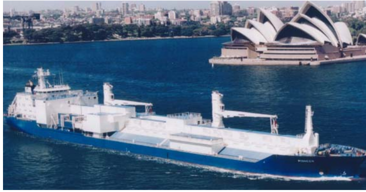
Slika 19. BIBO brod ( Bulk in, Bags out ).
