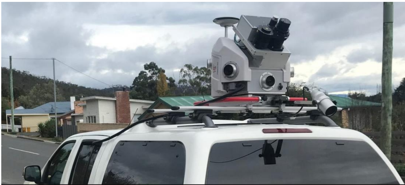
Slika 3. Primjer mobilnog MLS skenera [9]
