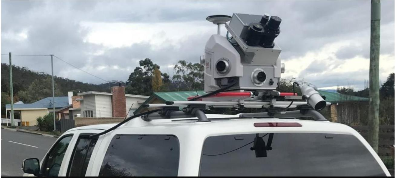
Slika 3. Primjer mobilnog MLS skenera [9]
