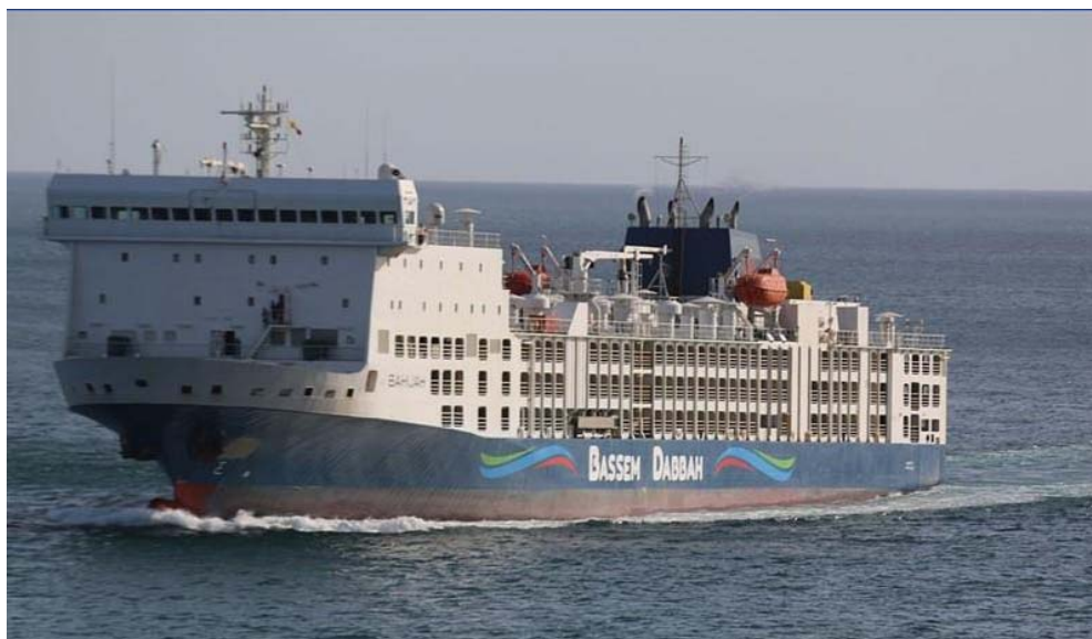
Slika 43. Brod sa otvorenim štalama Bahijah [13]
