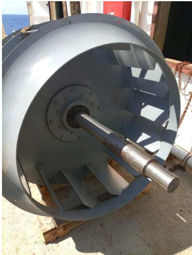
**Slika 10. Centrifugalni ventilator [2]**
