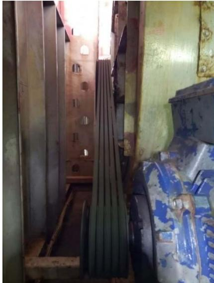
**Slika 11. Ventilator s remenim prijenosom [5]**
