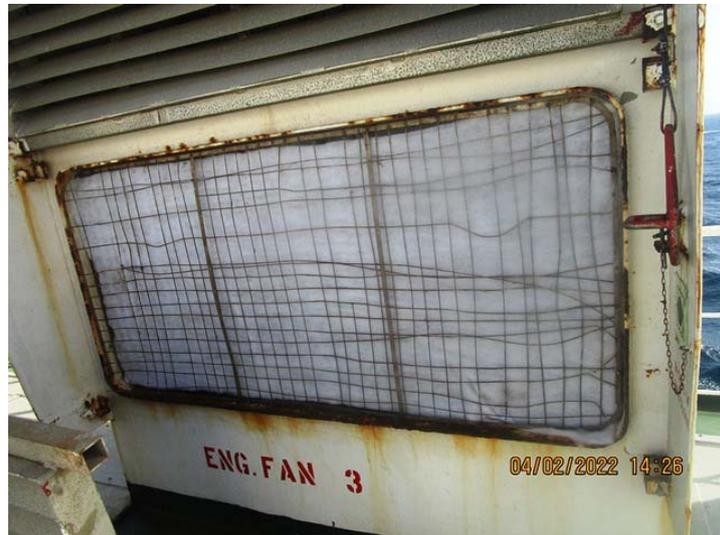
**Slika 16. Prikaz zaštite za ventilator**
