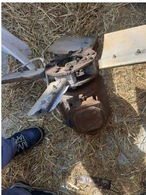
**Slika 33. Puknuće impelera**
