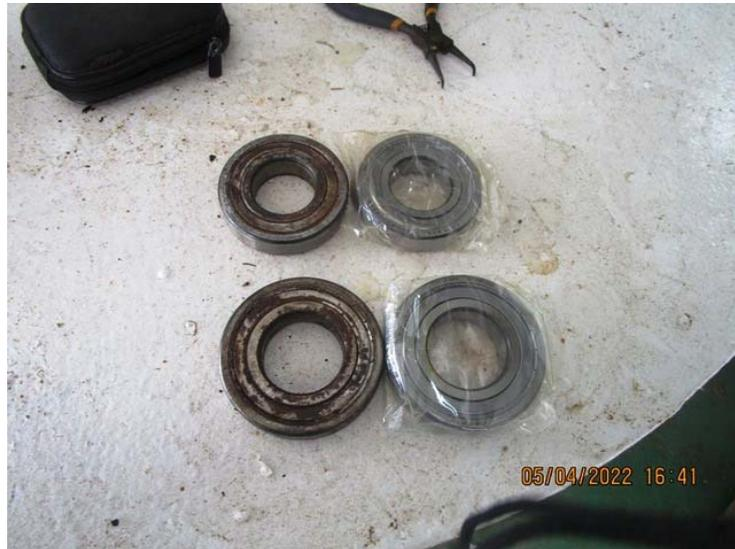
**Slika 37. Ležajevi elektromotora**
