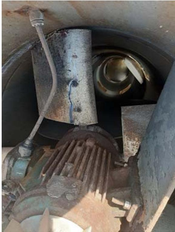
**Slika 31. Prikaz puknuća impelera**
