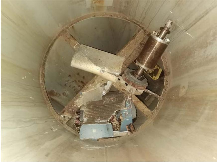
**Slika 35. Prikaz puknuća impelera i elektromotora**
