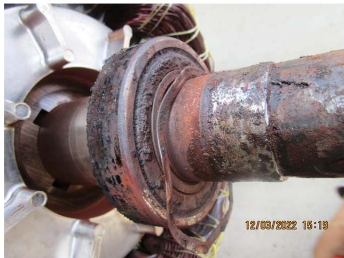
**Slika 38. Oštećeni ležaj**
