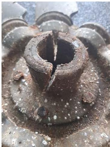
**Slika 30. Prikaz puknuća impelera**
