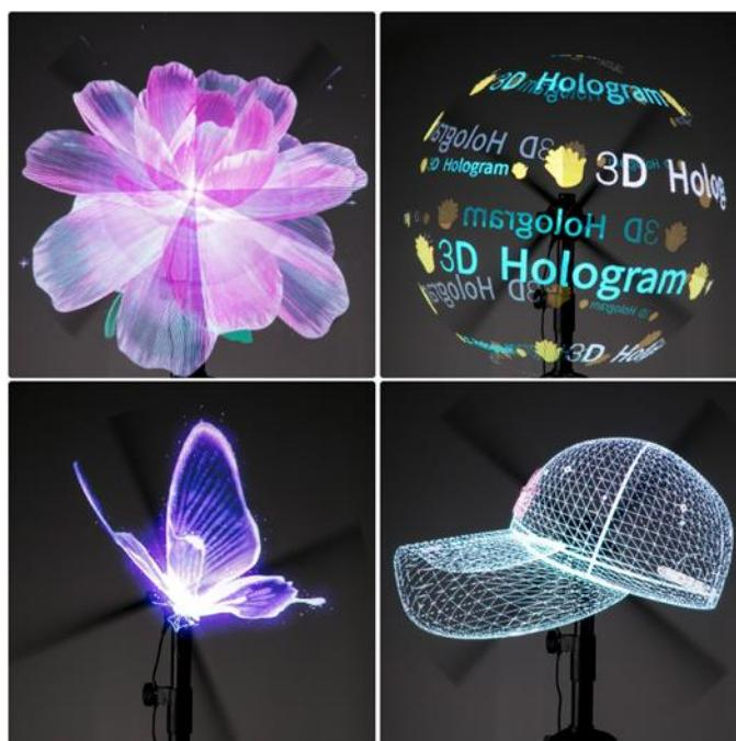
Slika 12 LED hologrami na bazi ventilatora [63]
