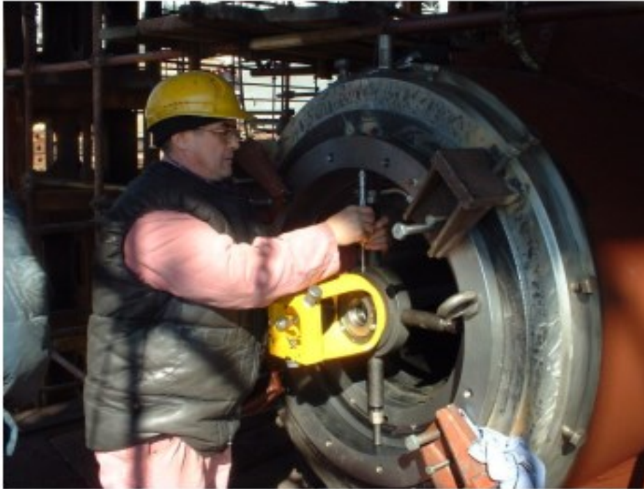
Slika 14. Postavljanje mete u centar stražnjeg ležaja
