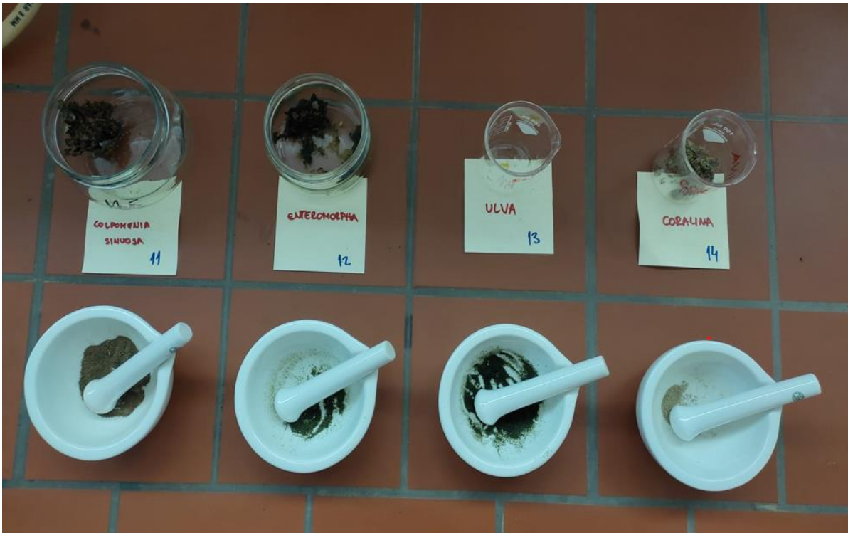
Slika 12. Usitnjavanje uzoraka algi nakon 24-satnog sušenja.
