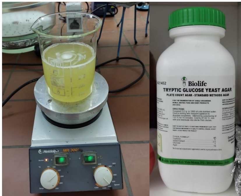
Slika 16. Prikaz pripreme Tryptic glucose yeast agar podloge.
