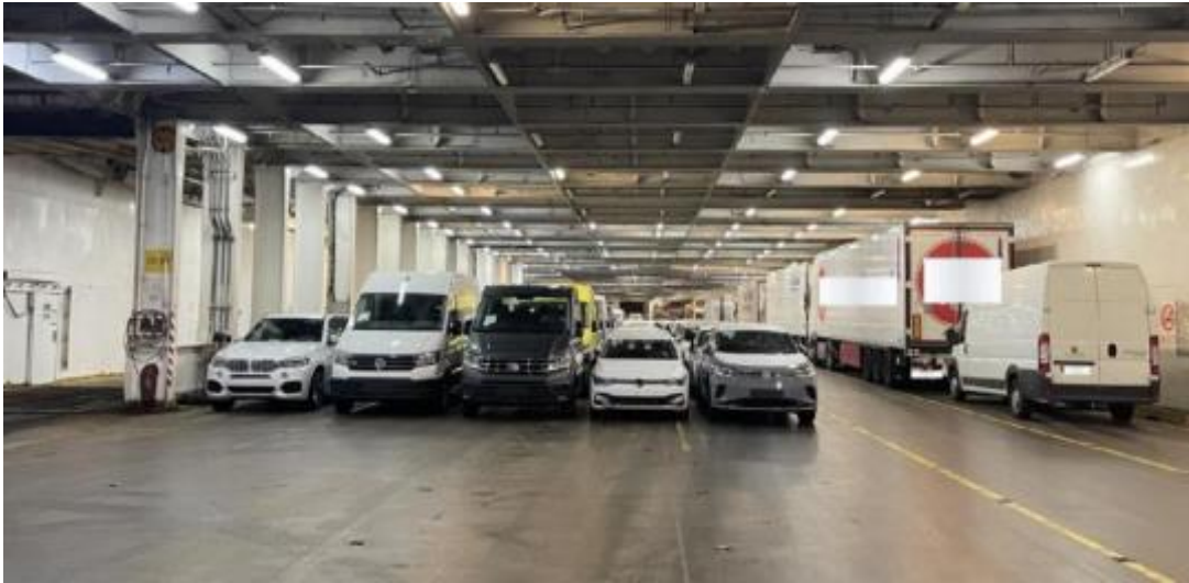
Slika 6. Samohodni teret, automobili i kamioni, utovareni na palubi
