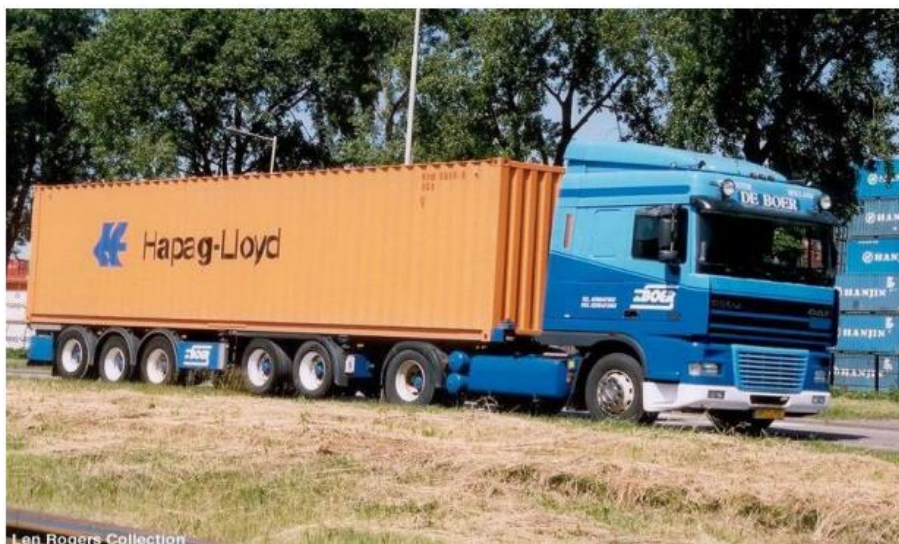
Slika 17. Tegljač s poluprikolicom
