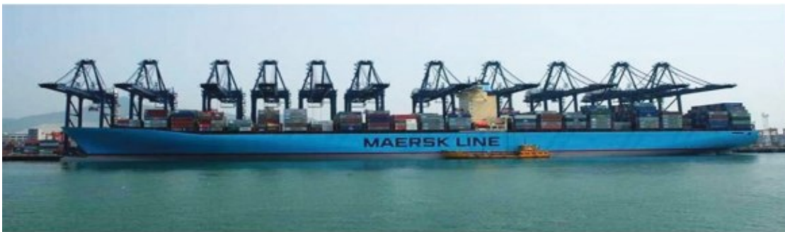
Slika 8. Brod „Emma Maersk“ sa prikazom broja pretovarnih dizalica koji opslužuju brod da bi se minimaliziralo vrijeme boravka u luci.
