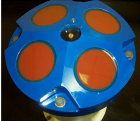
Slika 7. Glava ADCP senzora s četiri sonde
