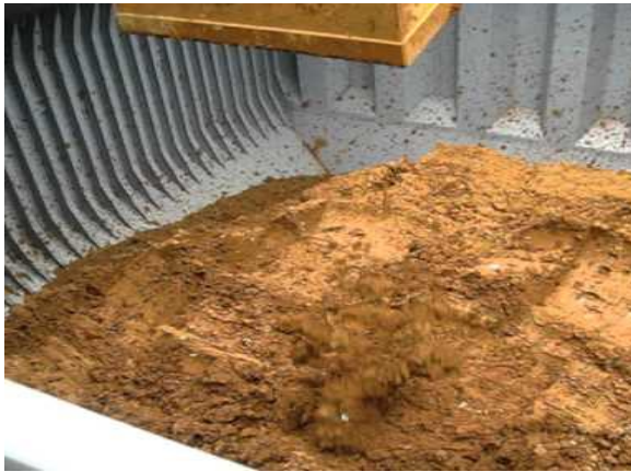
Slika 3. Krcanje rudače nikla u skladište.
