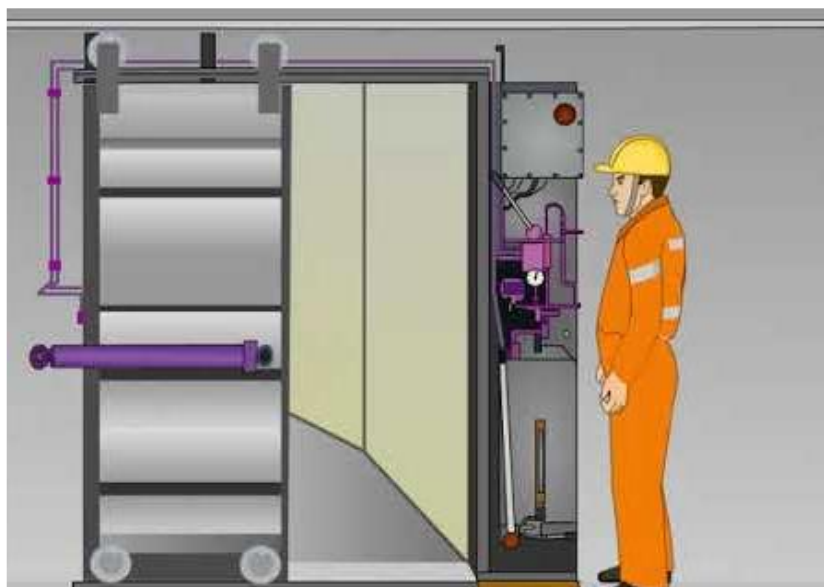
Slika 8.: Klizna vodonepropusna vrata [16]
