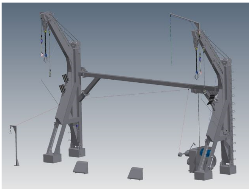
Slika 6.: Jednostruka gravitacijska soha
