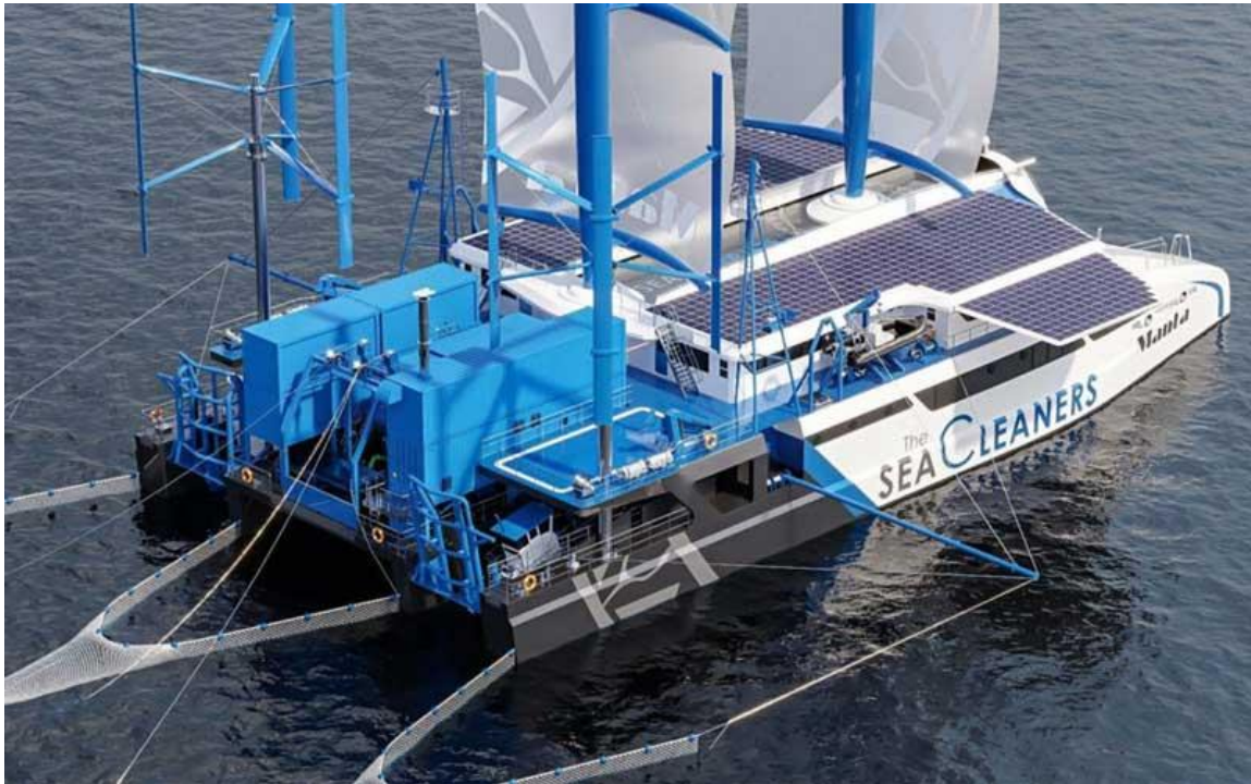
Slika 8. Autonomni brod za prikupljanje smeća MANTA 30
