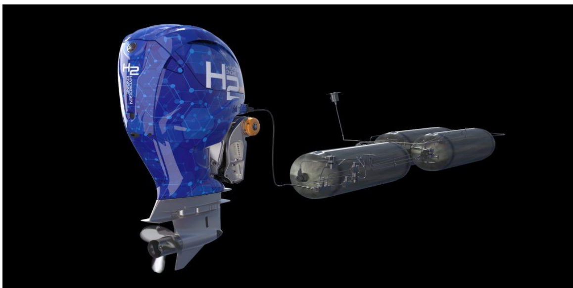
Slika 29. Yamaha vanbrodski motor na vodik 110
