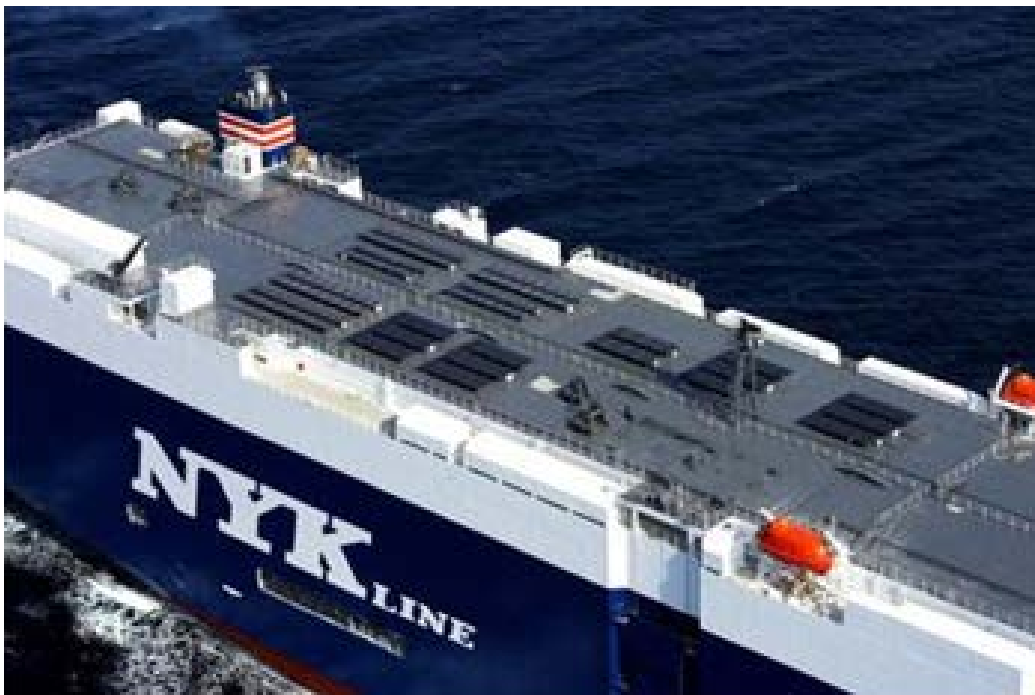
Slika 7. MV Auriga Leader s ugrađenim fotonaponskim modulima na gornjoj palubi [21].
