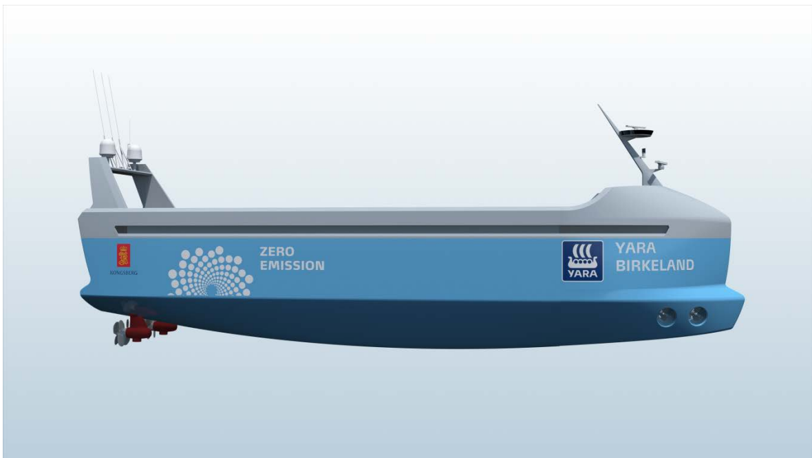
Slika 11. Projekt broda s akumulatorskim porivom [14].
