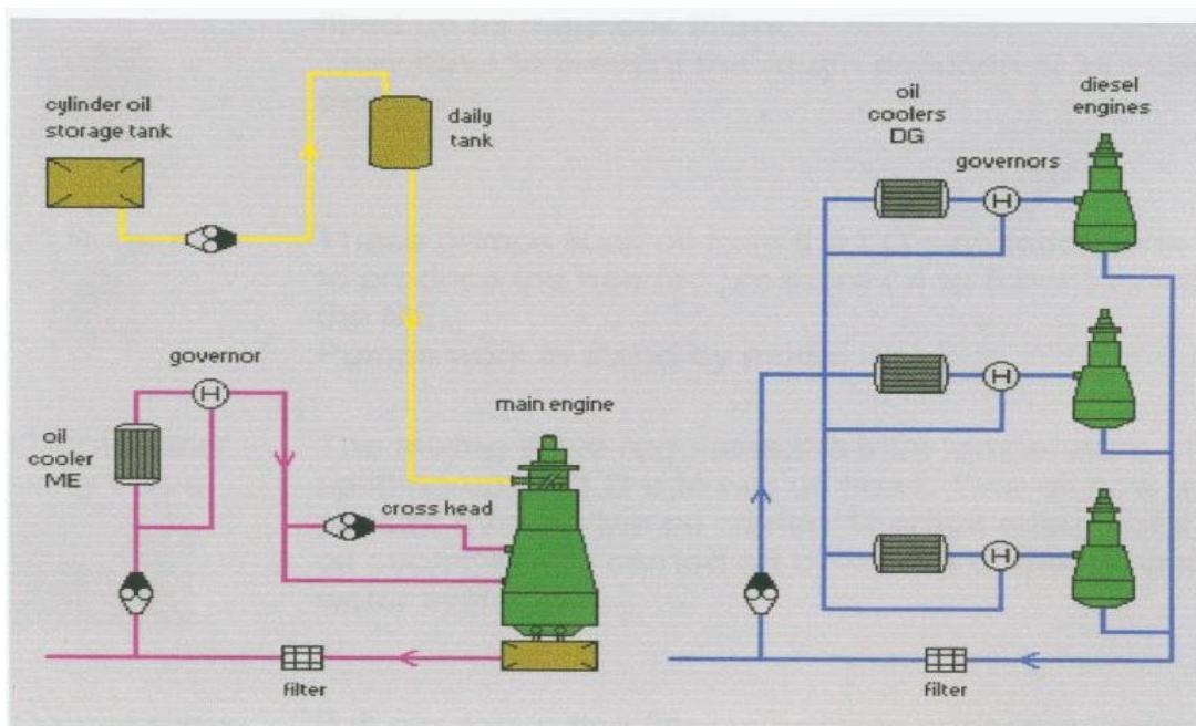
**Slika 9.** Sustav podmazivanja glavnog motora [7]
