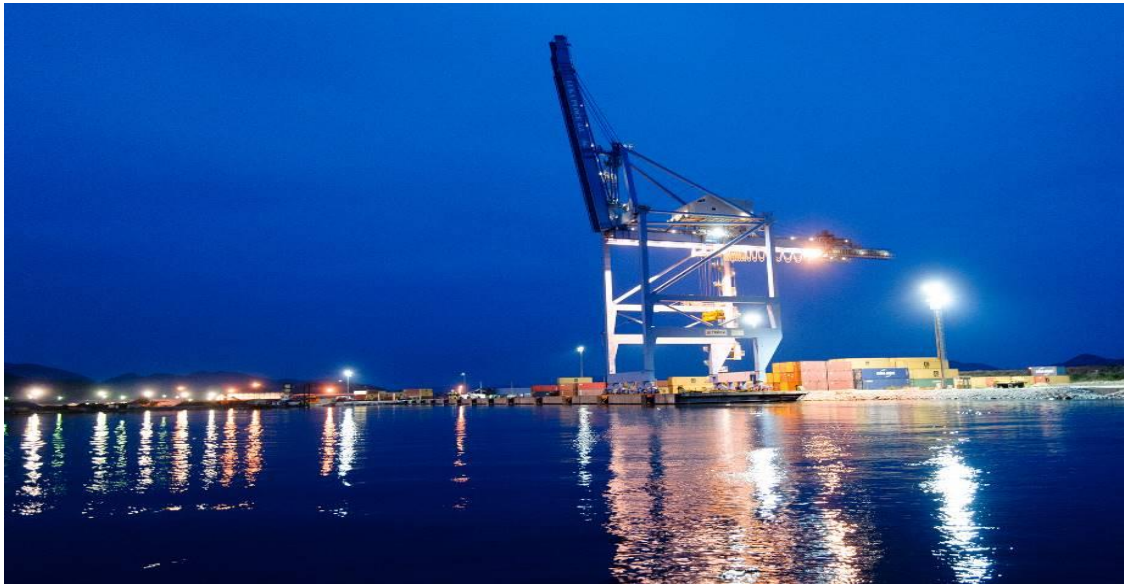
Slika 10. STS kontejnerska dizalica
