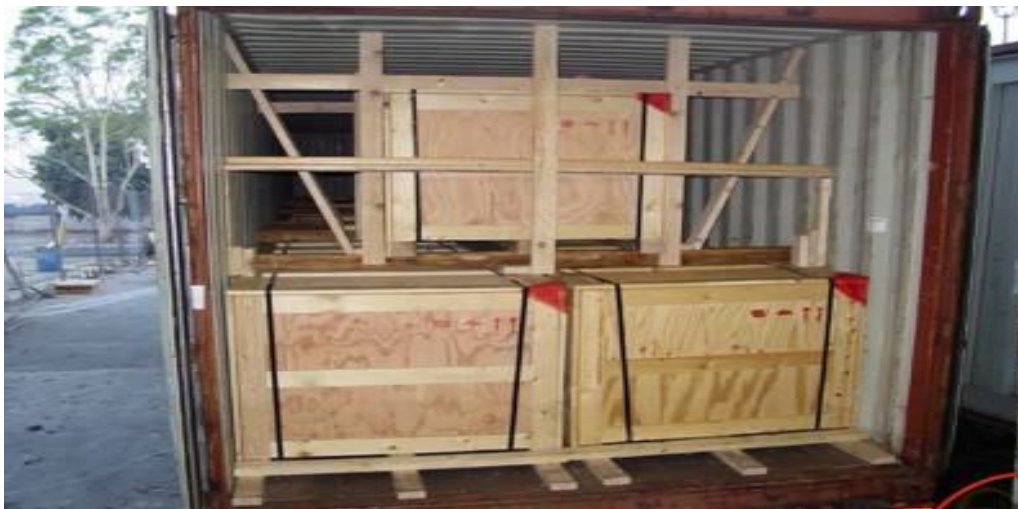
Slika 15. Prikaz pravilno osiguranog tereta u kontejneru
