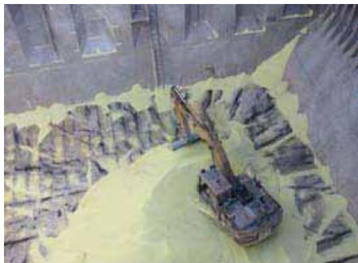
Slika 49. Završetak iskrcaja sumpora; potrebno je provjeriti moguća udubljenja na poklopcu dvodna
