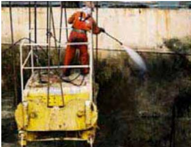
Slika 29. Čišćenje skladišta nakon iskrcaja petcoke
