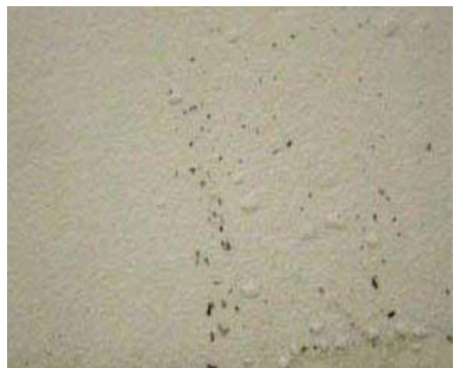
Slika 5. Završavanje iskrcaja željezne rude Slika 6. Kontaminacija uree sa bojom i hrđom
