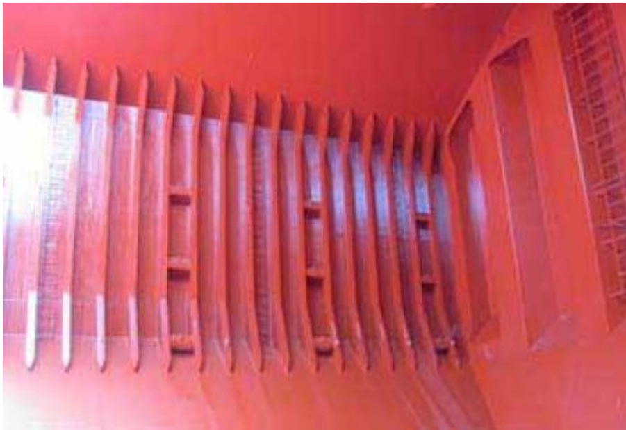
Slika 52. Bolnički čisto (Hospital clean) skladište
