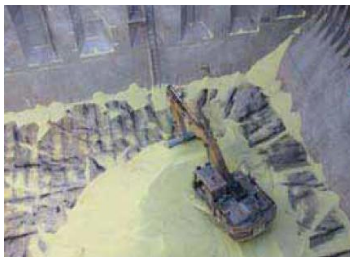
Slika 49. Završetak iskrcanja sumpora; potrebno je provjeriti moguća udubljenja na poklopcu dvodna
