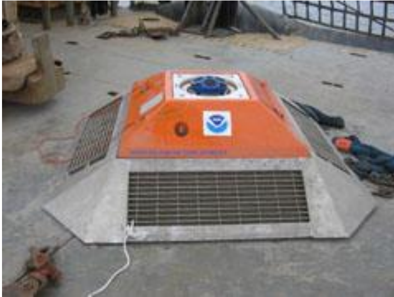
Slika 10. Izgled instrumenta koji radi na Dopplerov efekt; Izvor: https://aamboceanservice.blob.core.windows.net/oceanservice-prod/education/kits/currents/media/bottom_mount.jpg (zadnji pogled 2.5.2018.)
