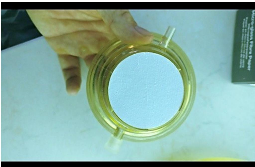
Slika 10. Munktell filter papir (veličina pora 0,45 µm) postavljen na filteru.
