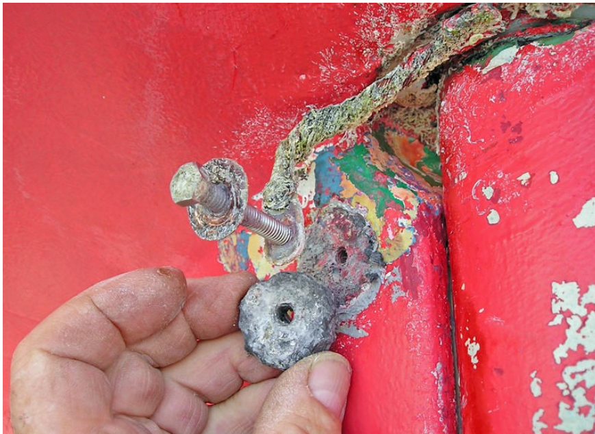
Slika 15 Primjer istrošenog cink protektora (preuzeto: http://nautica-portal.com/forum/index.php?topic=5103.30 )
