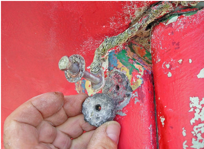
Slika 15 Primjer istrošenog cink protektora (preuzeto: http://nautica-portal.com/forum/index.php?topic=5103.30 )
