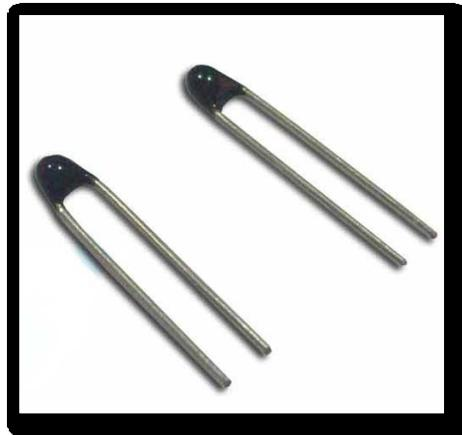
Slika 13. Poluvodič termorezistora s kuglicom [13]
