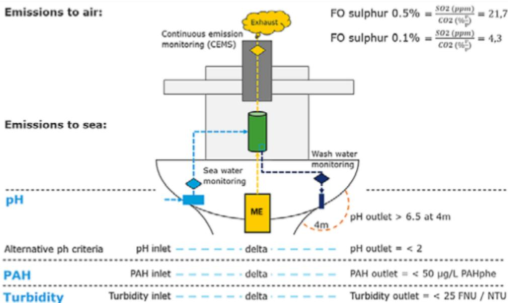
**Slika 5.** Kontinuirano praćenje radnih parametara u svrhu usuglašavanja sa zahtjevima za uređaje za pročišćavanje ispušnih plinova ( Izvor: DNV GL – Global sulphur cap 2020- 2019. update ( Focus on scrubbers ) )
