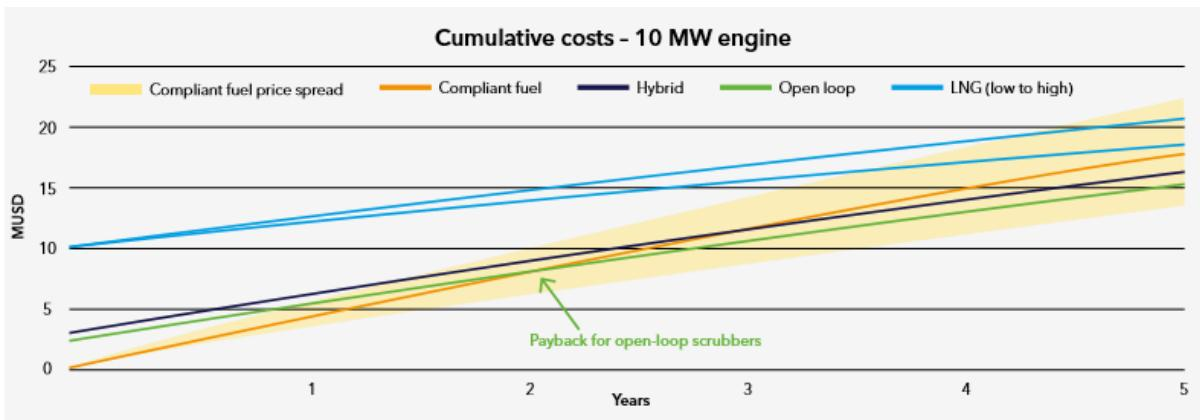
**Grafikon 11.** Procjena povrata ukupnih troškova investicije u pojedini tip skrabera i LNG na osnovu razlike cijene goriva na tržištu za glavni motor snage 10 MW ( Izvor: DNV GL – Global sulphur cap 2020- 2019. update ( Focus on scrubbers ) )
