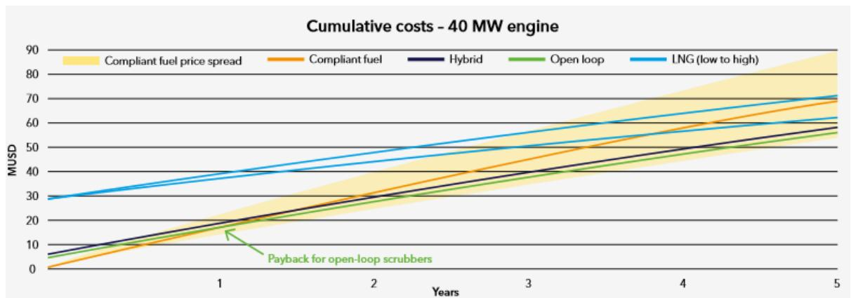
**Grafikon 12.** Procjena povrata ukupnih troškova investicije u pojedini tip skrabera i LNG na osnovu razlike cijene goriva na tržištu za glavni motor snage 40 MW ( Izvor: DNV GL – Global sulphur cap 2020- 2019. update ( Focus on scrubbers ) )
