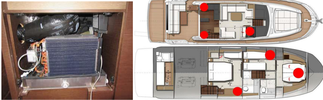
Slika 35. Izgled i smještaj ventilatora po prostorijama [3]
