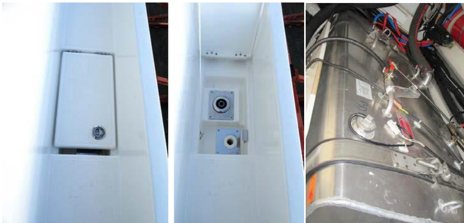
Slika 7. Priključci za gorivo (lijeva i desna strana) i tank goriva [3]
