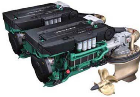
Slika 6. Motori spojeni s IPS sustavom [3]
