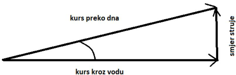
Slika 4. Metoda direktnog mjerjenja struje
