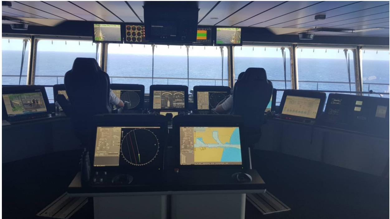
Slika 12. Vidljivost s pozicijemjesta upravljanja sa svim dostupnim uređajima za navigaciju, tzv. INS (*Integrated Navigational System*)
