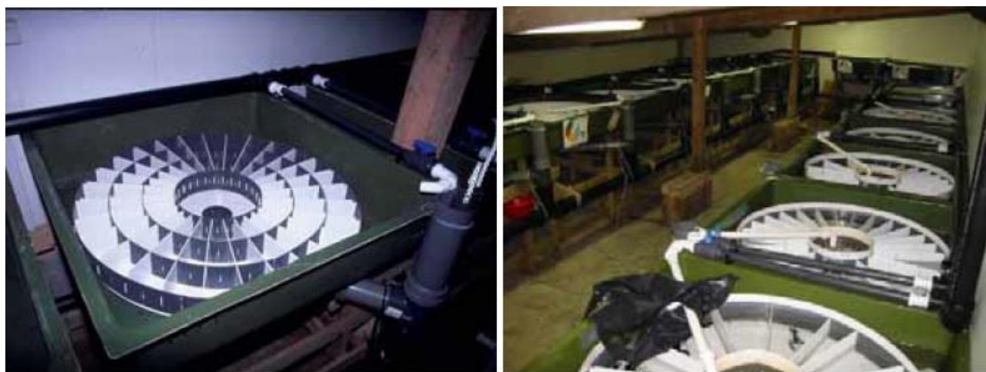
Slika 9. Sustav odjeljaka za uzgoj hlapa u horizontalnom kotaču
