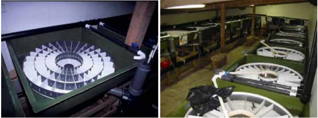
Slika 9. Sustav odjeljaka za uzgoj hlapa u horizontalnom kotaču
