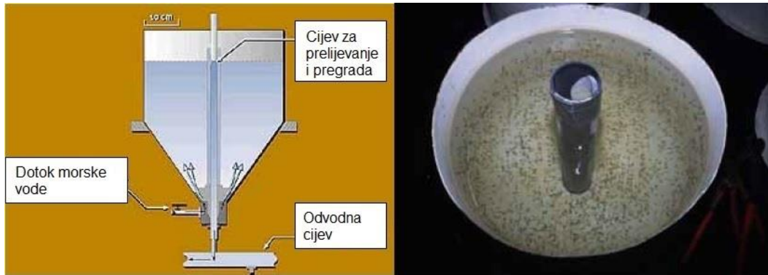
Slika 5. Shematski prikaz inkubatora i slika inkubatora za ličinke hlapa
