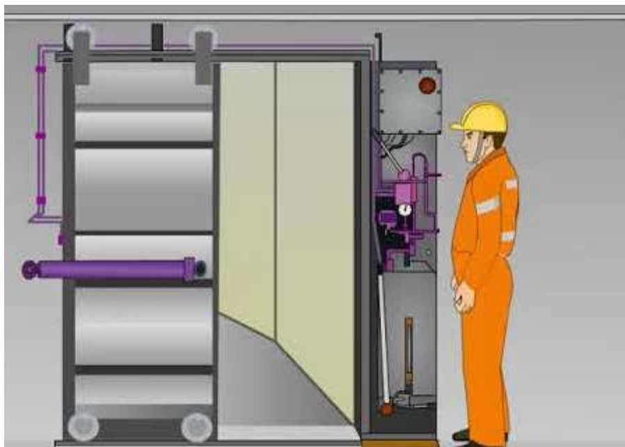
Slika 12. Klizna vodonepropusna vrata
