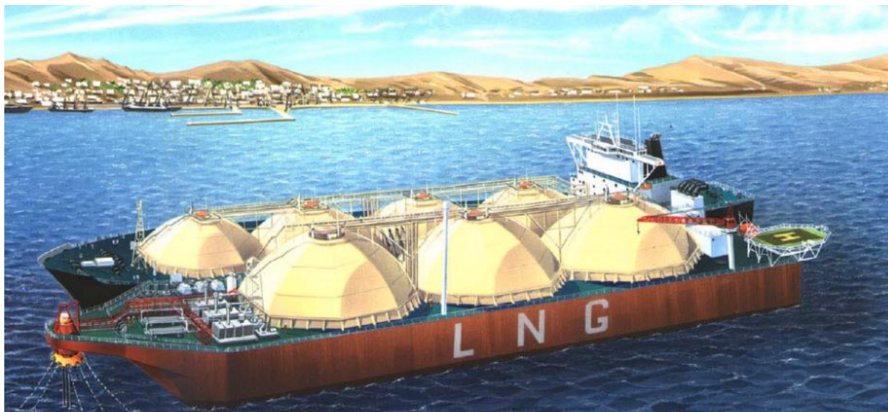
Slika 6. Plutajuće postrojenje za skladištenje i uplinjavanje LNG-a [10]
