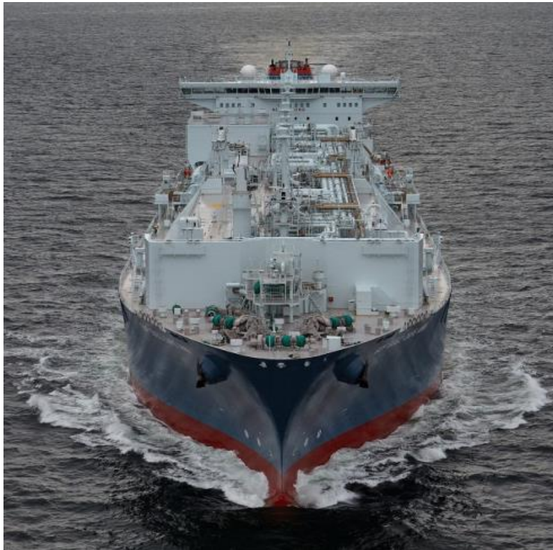
Slika 5. Brod za prijevoz LNG-a sa sustavom za uplinjavanje [13]
