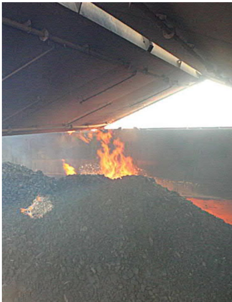
Slika 22. Požar u brodskom skladištu uslijed samozapaljenja ugljena
