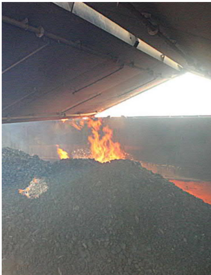
Slika 22. Požar u brodskom skladištu uslijed samozapaljenja ugljena
