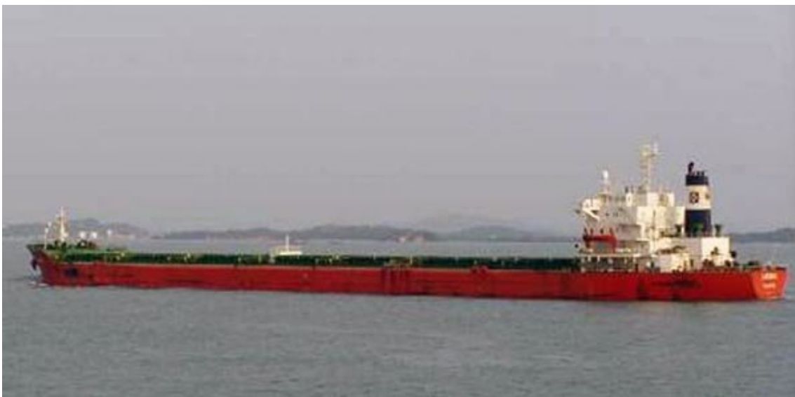
Slika 2. Brod za prijevoz rasutih tereta bez opreme za rukovanje teretom
