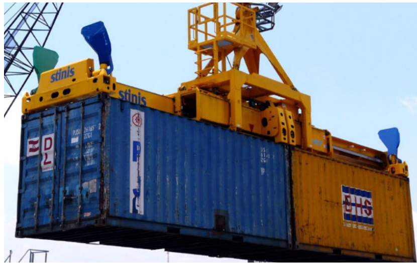
Slika 12. Spreader za zahvaćanje dva kontejnera od 20 stopa
