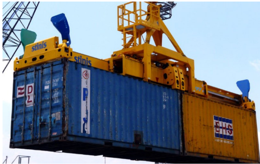
Slika 12. Spreader za zahvaćanje dva kontejnera od 20 stopa
