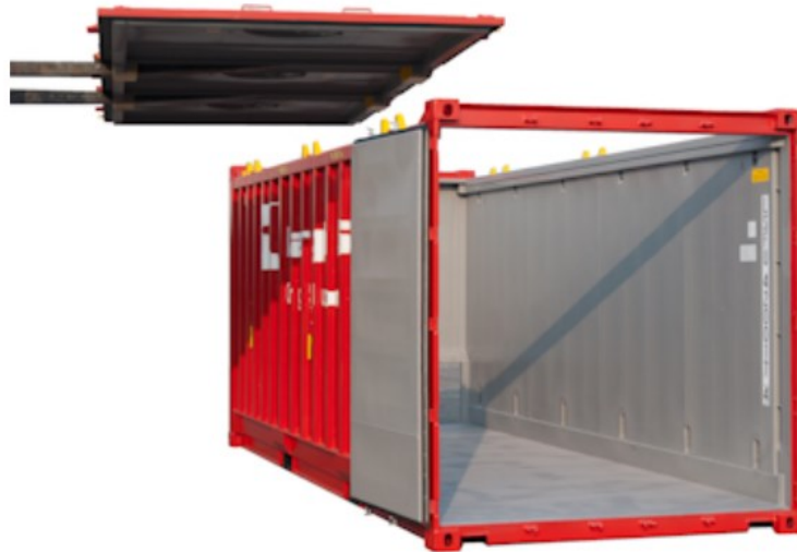
Slika 6. 20-stopni kontejner sa otvorenim vrhom
