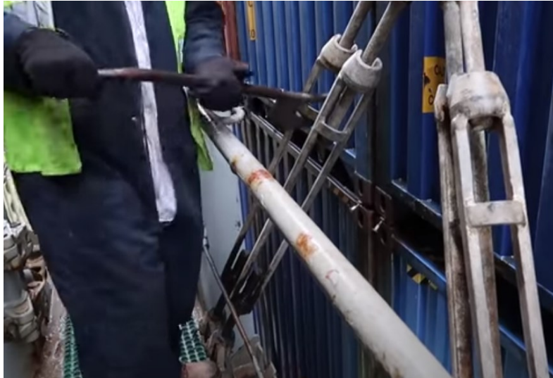
Slika 21. Prikaz lučkog radnika pri učvršćivanju stezaljke ( turnbuckle )
