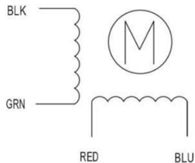
Slika 3.2 Dijagram koračnog motora NEMA 17 [25]
