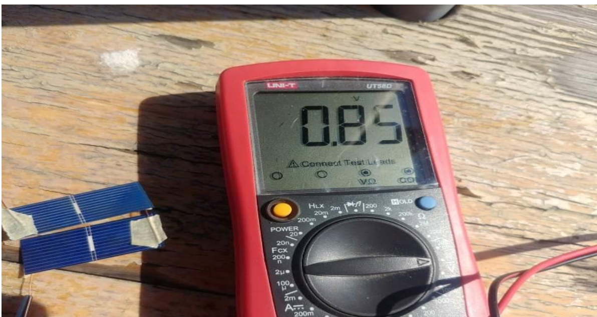
Slika 4.13 Provjera učinkovitosti solarnih panela (prije mraka)
