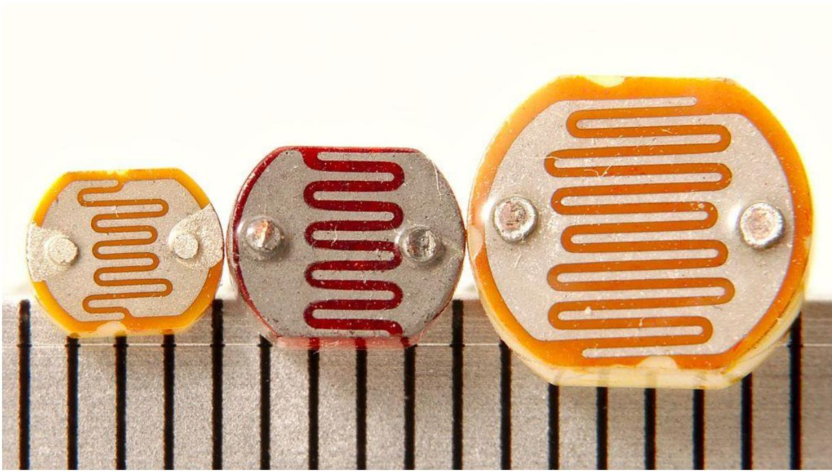
Slika 3.7 Fotootpornik različitih dimenzija prikazani u milimetrima [30]
