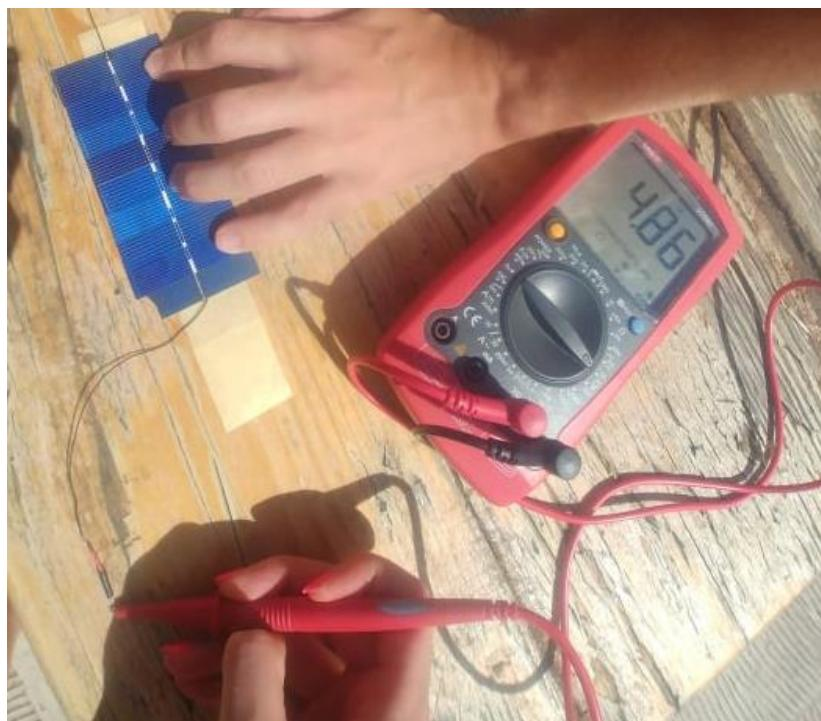
Slika 4.9 Spoj solarnih panela u seriju (5 V)
