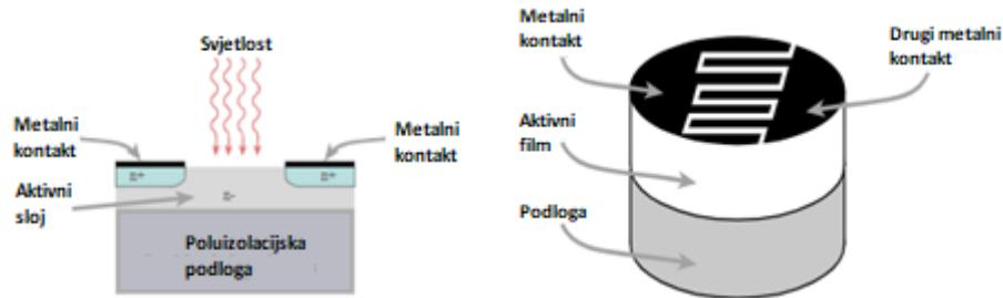
Slika 3.9 Struktura fotootpornika [32]
