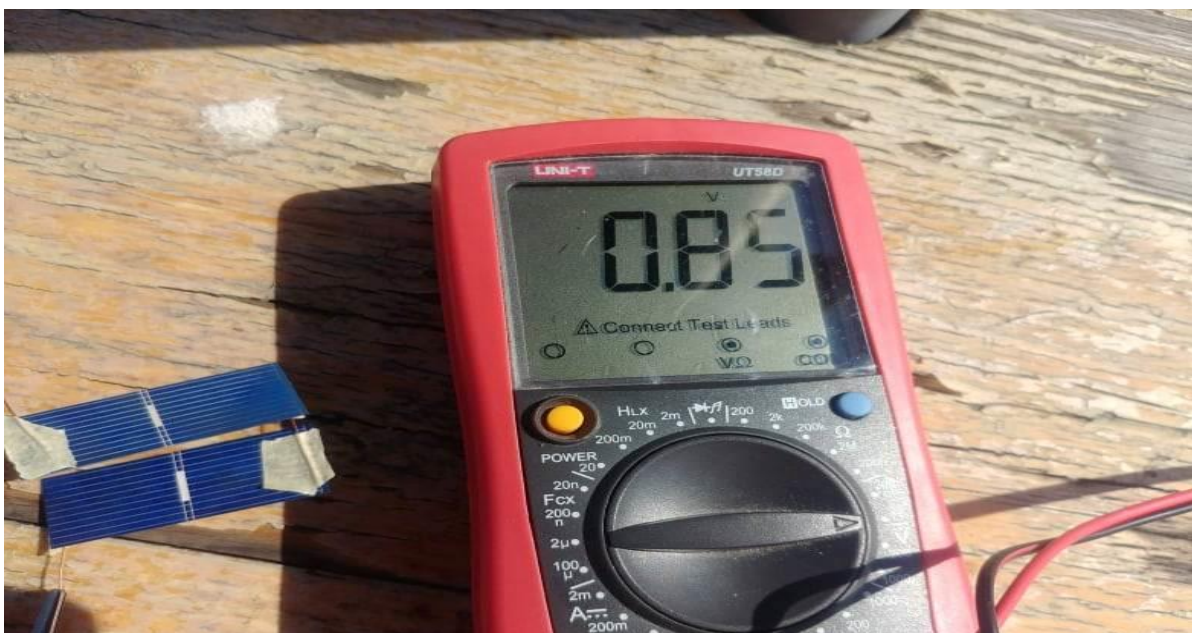
Slika 4.13 Provjera učinkovitosti solarnih panela (prije mraka)
