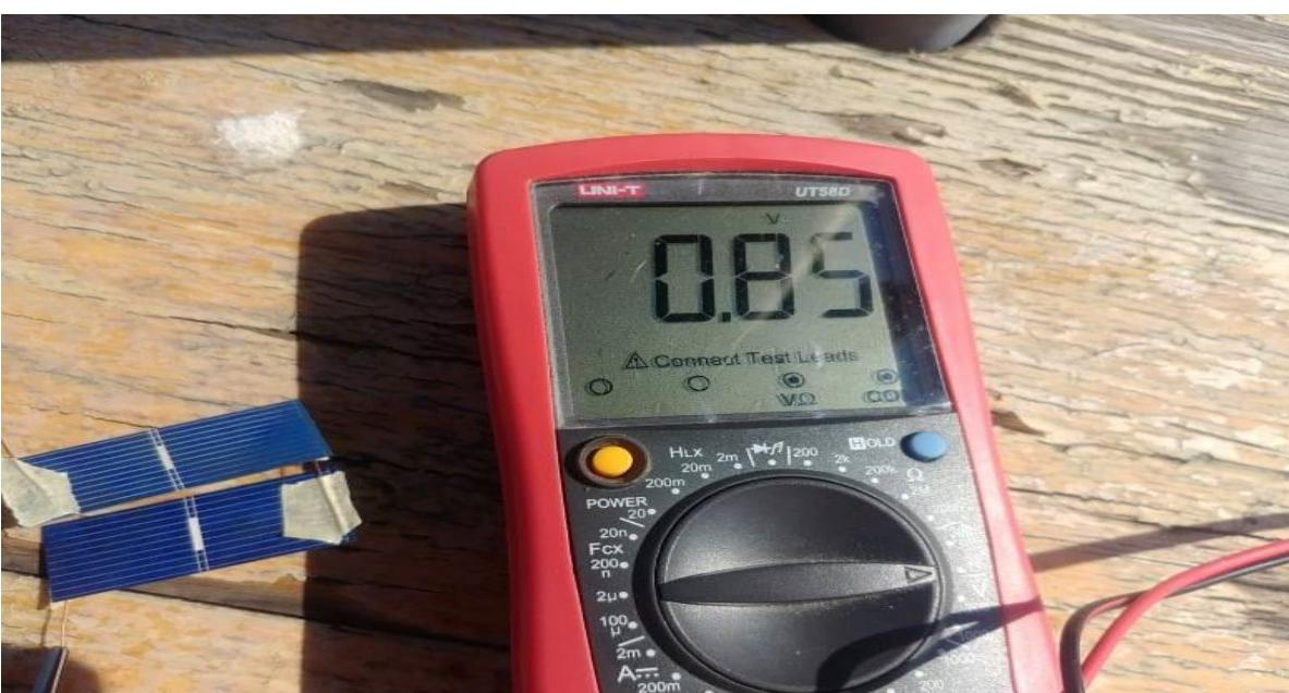
Slika 4.13 Provjera učinkovitosti solarnih panela (prije mraka)
