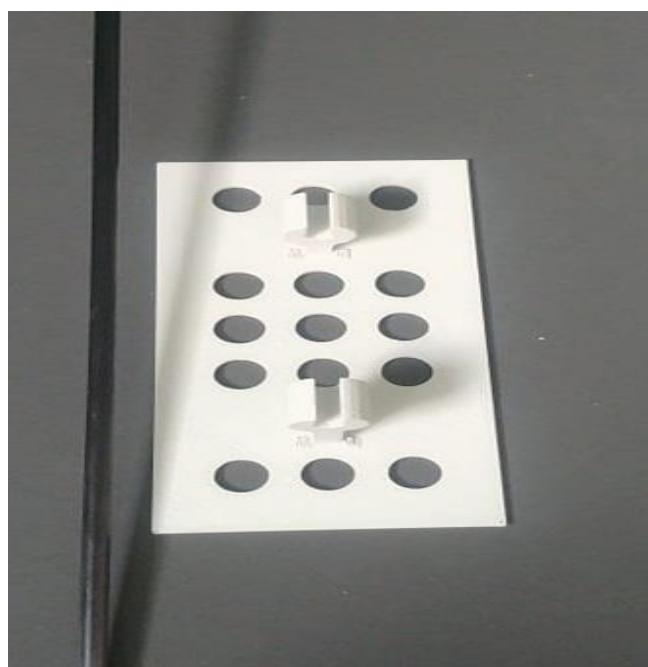
Slika 2.14 Primjer nosača za solare i karbonskog štapića
