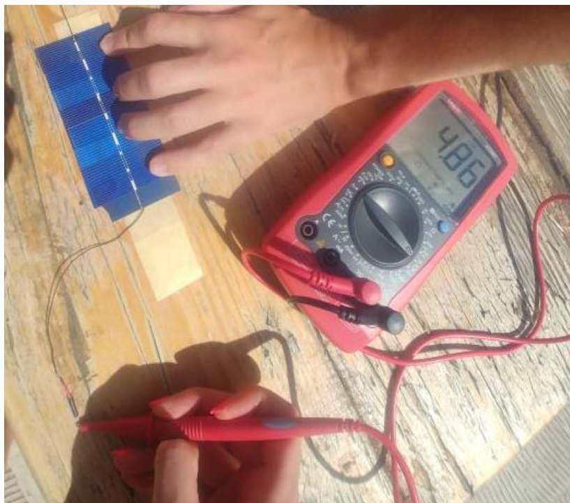
Slika 4.9 Spoj solarnih panela u seriju (5 V)
