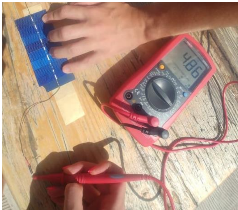
Slika 4.9 Spoj solarnih panela u seriju (5 V)
