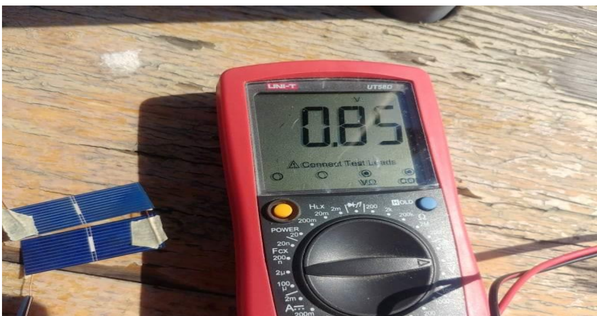
Slika 4.13 Provjera učinkovitosti solarnih panela (prije mraka)
