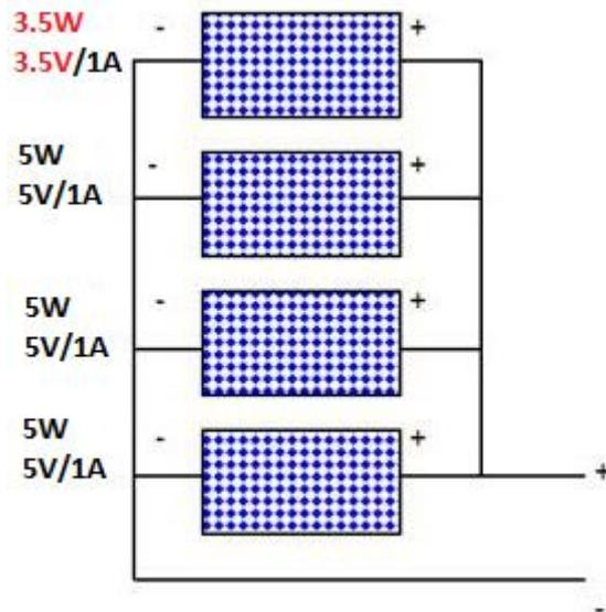
Slika 4.6 Paralelni spoj solarnih panela različitih napona
