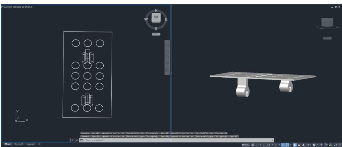
Slika 2.10 Nosač za fotonaponske panele
