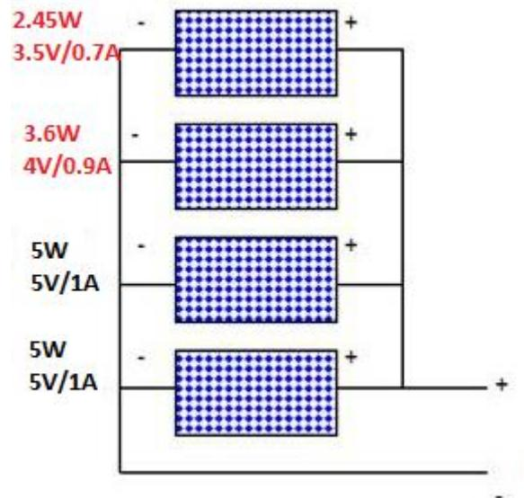
Slika 4.7 Paralelni spoj solarnih panela različitih napona i struja
