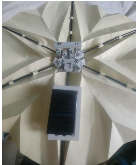
Slika 4.15 Otvoreni položaj solarnog origami modula
