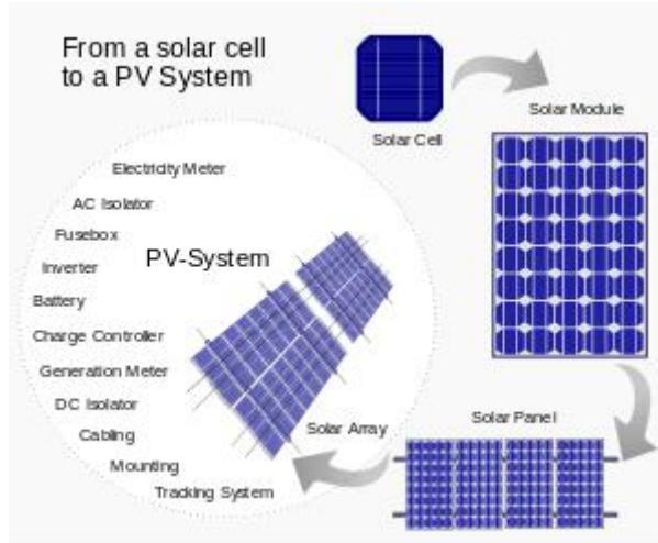
Slika 1.6 Spajanje fotonaponske ćelije unutar fotonaponskog sustava [16]
