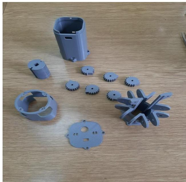
Slika 2.15 Primjer isprintanih dijelova solarnog origamija
