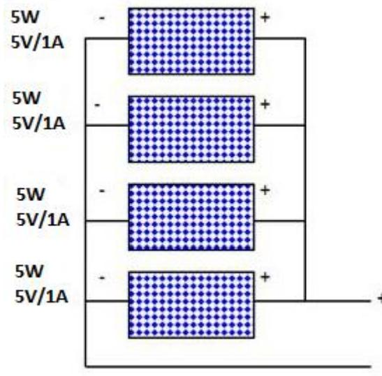
Slika 4.5 Paralelni spoj solarnih panela
