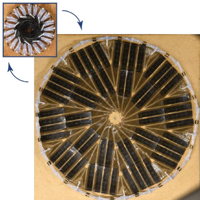
Slika 1.2 Solarni paneli presavijeni na način origamija [4]
