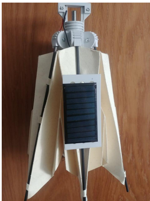
Slika 4.17 Izgled sklopljenog solarnog origami modula
