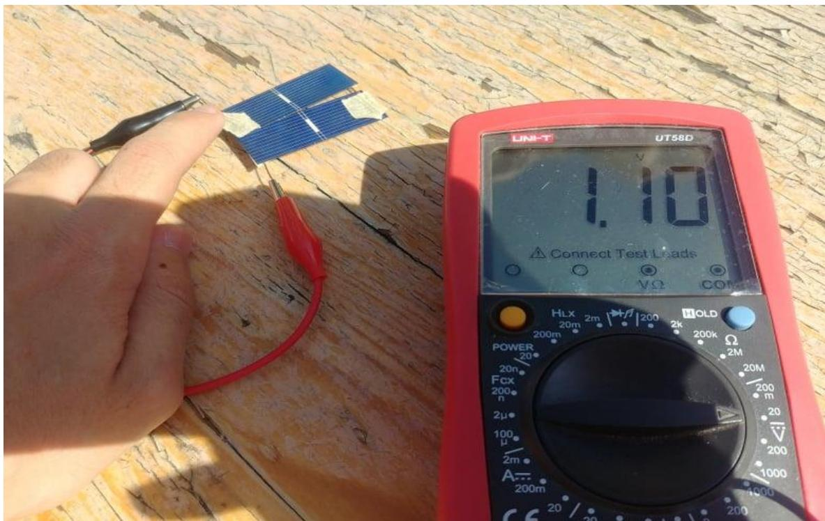
Slika 4.12 Provjera učinkovitosti solarnih panela (tijekom dana)
