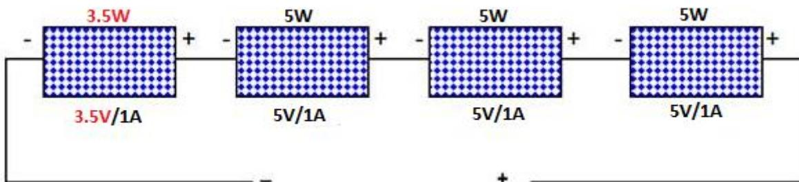
Slika 4.3 Serijski spoj solarnih panela različitih napona
