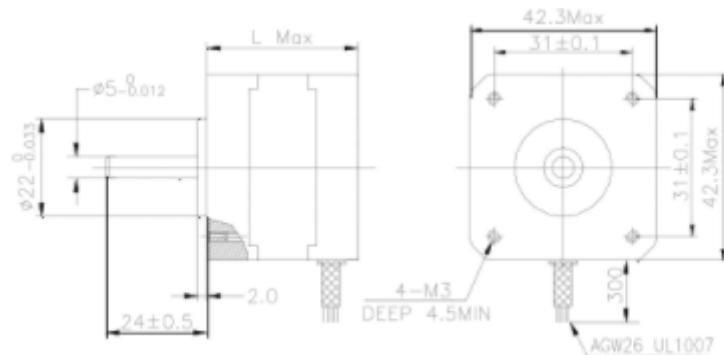
Slika 3.3 Shema koračnog motora NEMA 17 [25]
